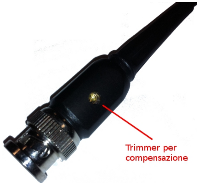
Foto 1: Corpo di sonda con trimmer per la compensazione.
